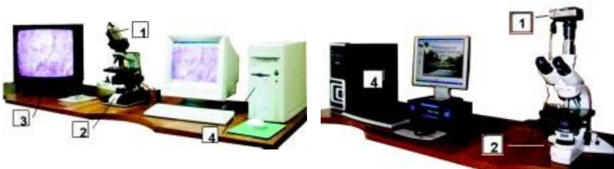
Рис. 1. Телемедицинская система макро- и микроскопии: 1 — цифровая фотокамера или фотоаппарат; 2 — микроскоп; 3 — телевизор; 4 — компьютер.
